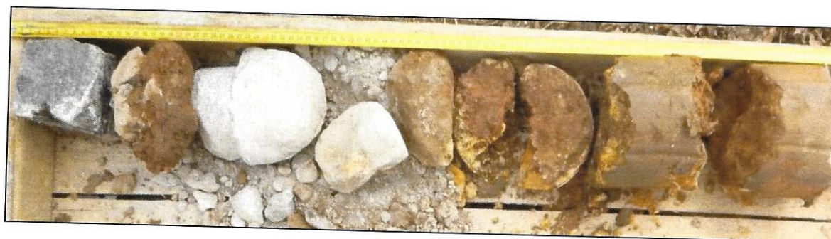
Foto 3 : charakteristická skladba konstrukce v úseku s žulovým dlážděním
