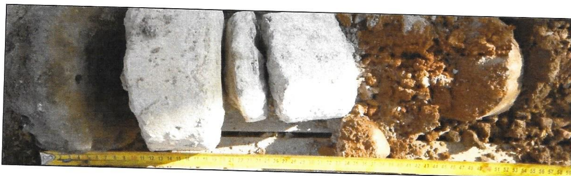
Foto 2 : charakteristická skladba konstrukce v úseku s betonovým podkladem
